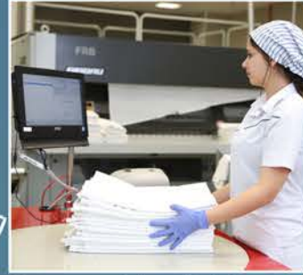
Yıkama sonrası katlanan ürünlerin sayımı pacman cihazında yapılır.
