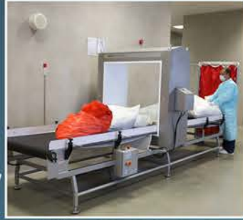
Kirlı tekstil poşetleri içerisinde iğne vb personele zarar verebilecek yabancı madde kontrolü için poşetler metal dedektörü içerisinde geçirilir.
